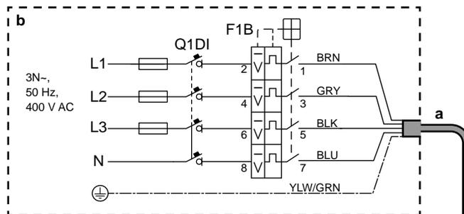
**a** Stromversorgungskabel (bauseitige Bereitstellung)
