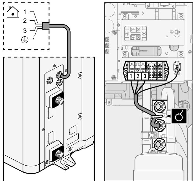
**3 (optional) Ablaufschlauchheizelement-Kabel:**
