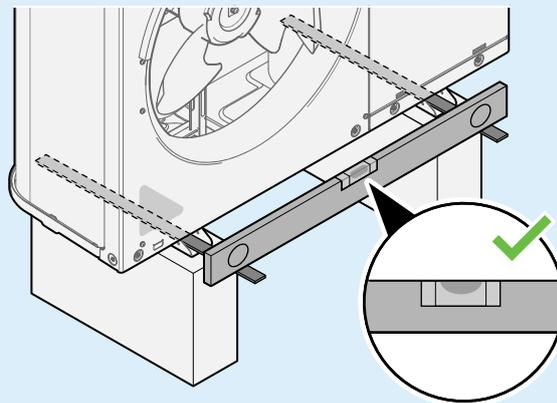
Verwenden Sie 4 Sätze mit M12-Ankerbolzen, Muttern und Unterlegscheiben. Lassen Sie mindestens 150 mm Freiraum unter dem Gerät. Stellen Sie zusätzlich sicher, dass das Gerät mindestens 100 mm über der maximal zu erwartenden Schneehöhe positioniert ist.
