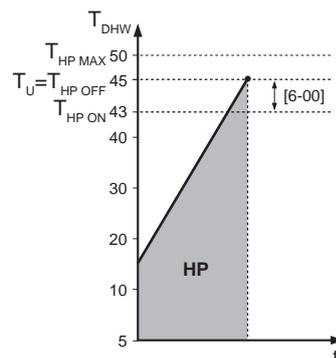
**HP** Wärmepumpe. Wenn die Aufwärmzeit durch die Wärmepumpe zu lange dauert, kann zusätzliche Erwärmung durch die Reserveheizung erfolgen.
