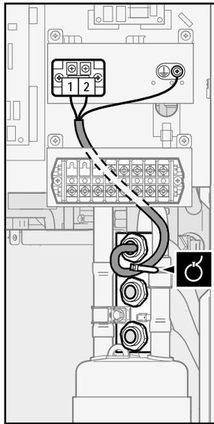
9.2.2 So positionieren Sie den Außenluftfühler am Außengerät um
