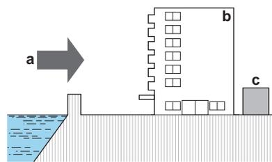
Ist die Außeneinheit direktem Wind vom Meer ausgesetzt, installieren Sie einen Windschutz.
