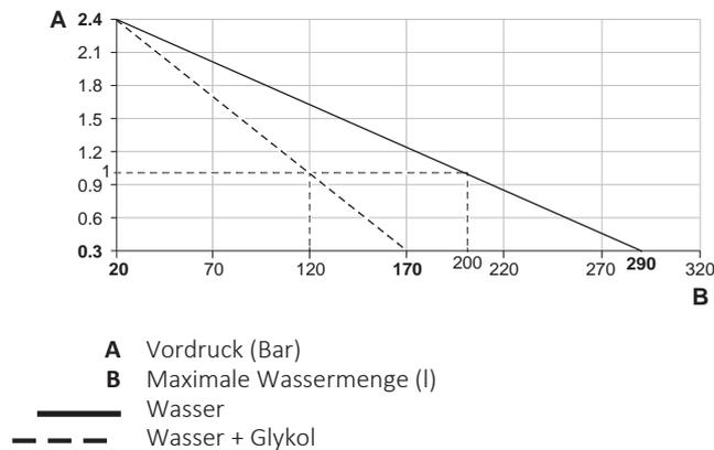
**Beispiel: Maximale Wassermenge und Vordruck des Ausdehnungsgefäßes**
